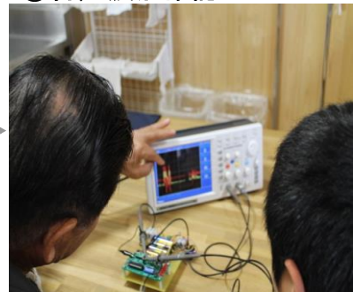
各自でオシロスコープを使用して音声波形を調整・確認する
