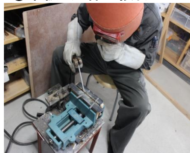
帯材と丸棒をアーク溶接で接合する
