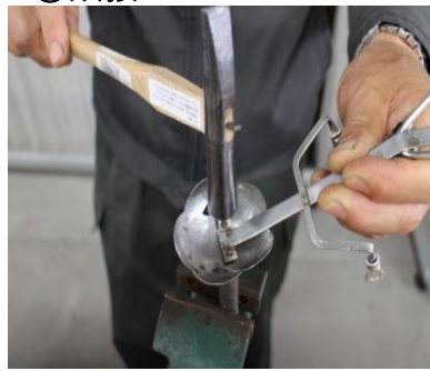
犬の眼・鼻を銅のリベットを利用し、かきつけて取り付ける
