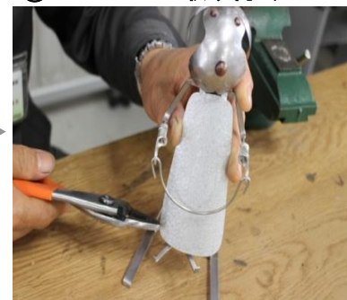
薄いガルバ鋼板を金切バサミで切断し、湾曲させてエプロンをつくる
