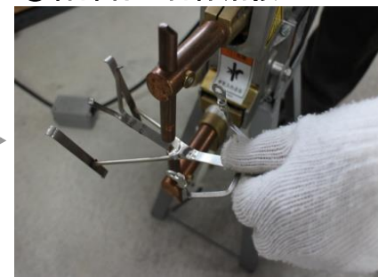
各パーツをスポット溶接で接合し、組み立てる
