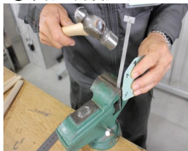
帯材のねじれ、返りを取り、安全に作業するための準備をして曲げる
