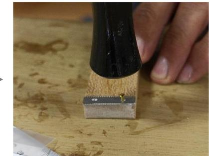
ボール盤で持ち手の穴を開け、カッター面に、歯を釘打ちする。
