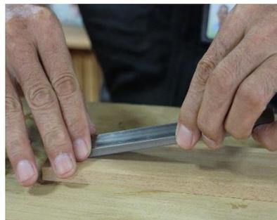
底板に金属の重しと、ペン立て用フェルトを両面テープで貼付ける。
