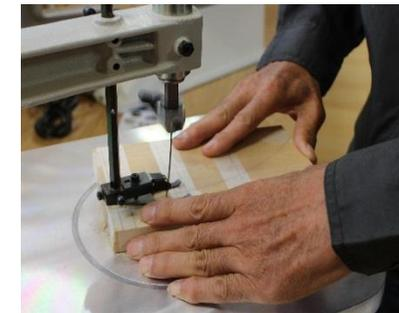
側板2枚を養生テープで貼り付け、糸ノコでカーブに沿って切断する。
