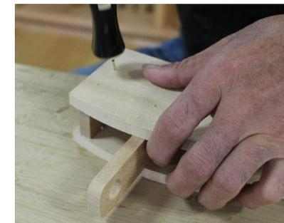
真ちゅう釘を打ち、底板裏面に滑り止めを貼る。
