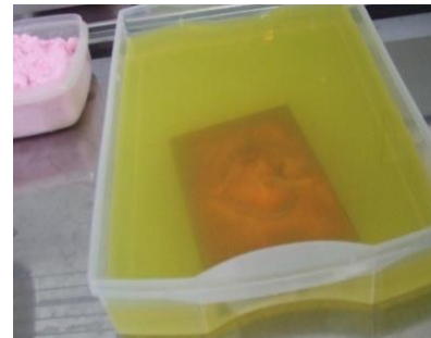
銅板表面の油脂を洗剤で落とし、黒化液で黒染めし、水で洗う。
